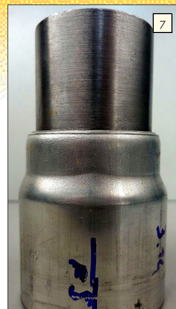
Fig. 6a: section métallographique d'une soudure cuivre/acier typique (x12) Fig. 6b: interface d'une soudure cuivre/acier (x200); Fig. 6c: interface d'une soudure cuivre/acier (x500); Fig. 7: soudure aluminium/acier typique
