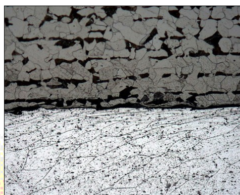
Figure 8 b: interface d'une soudure aluminium/acier (attaquée) (x200)
