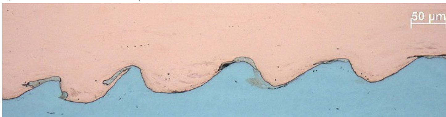
Figure 5b: interface d'une soudure cuivre/acier inoxydable, non attaquée (x200)
