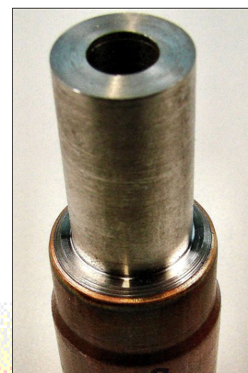
Figure 4: soudage des tubes en cuivre sur des pièces en acier inoxydable
