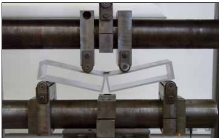
Figure 4a: Montage d'essais spécifiques pour l'application 1: dispositif pour l'essai de pliage en quatre points (simulation d'une charge répartie uniformément sur un plancher de chargement) à l'IBS
