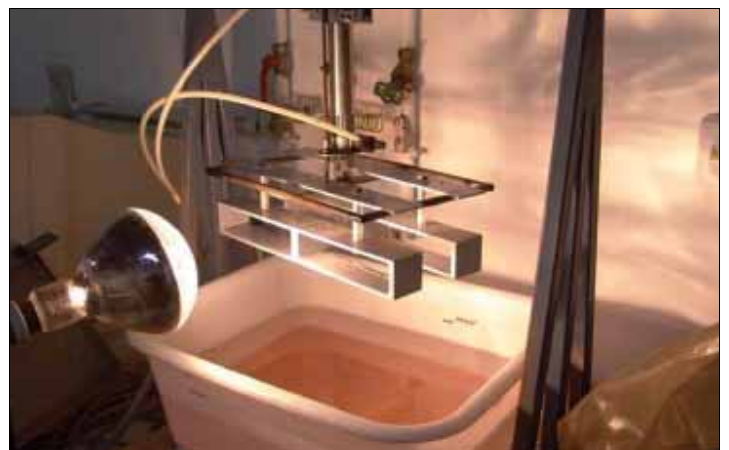
Figure 4b: Montage d'essais spécifiques pour l'application 1: dispositif pour l'essai d'immersion (simulation d'exposition aux sels du dessous du plancher de chargement) à l'UGent
