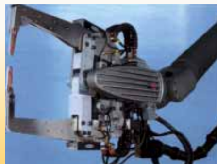
Figure 1 (à droite): pince pour soudage par points avec adhésif intégré / Figure 2 (en haut): différence en développement de chaleur avec les mêmes paramètres de soudage (force, courant, temps de soudage) lors du soudage par points d'acier avec adhésif (à gauche) et lors du soudage par points conventionnel sans adhésif (à droite)
