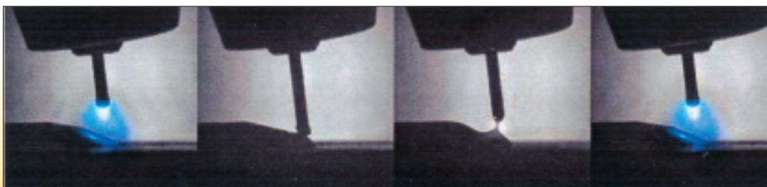
Figure 7: Présentation schématique du procédé CMT, avec du retrait du fil de soudage
