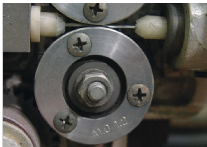
Figure 5: indication sur galet convenant pour fil d'aluminium
