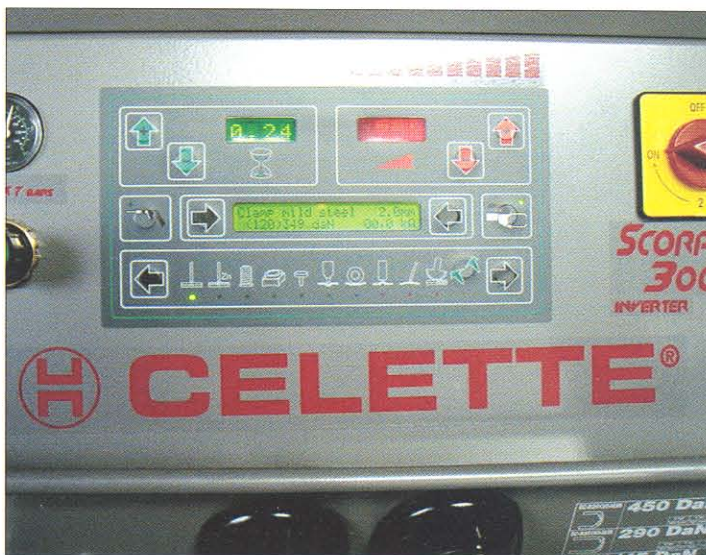
Figuur 2: instelmogelijkheden modern puntlasapparaat
