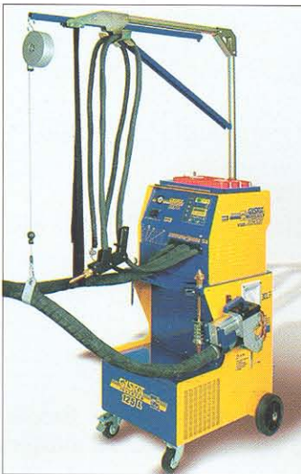
Figuur 3: opstelling vloeistof gekoeld inverter puntlastoestel
