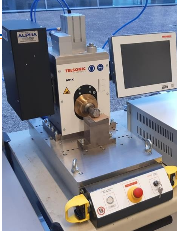
Ultrasoonlasmachine in het Belgisch Instituut voor Lastechniek
