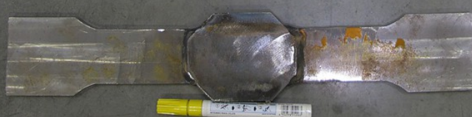
Figuur 9: vermoeingsproefstaven met lasdetails van de kritische details van kraanbanen
