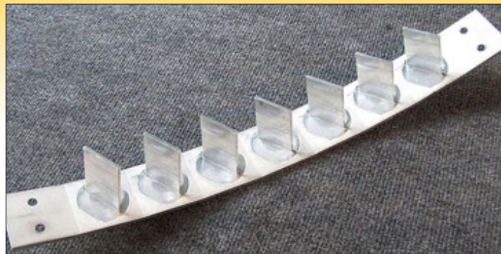
Figuur 12: friction stir van aluminium 2xxx aan aluminium 6xxx (luchtvaarttoepassing; bron: CEWAC)
