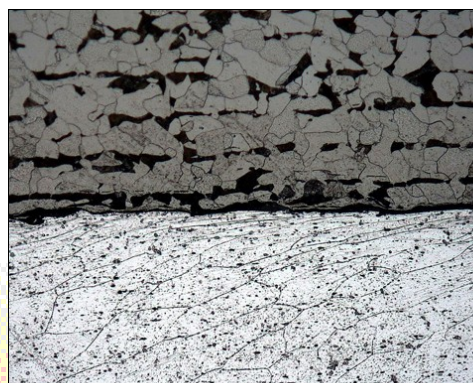
Figuur 8 b: lasinterface van een verbinding aluminium/staal, aangeëët (x200)
