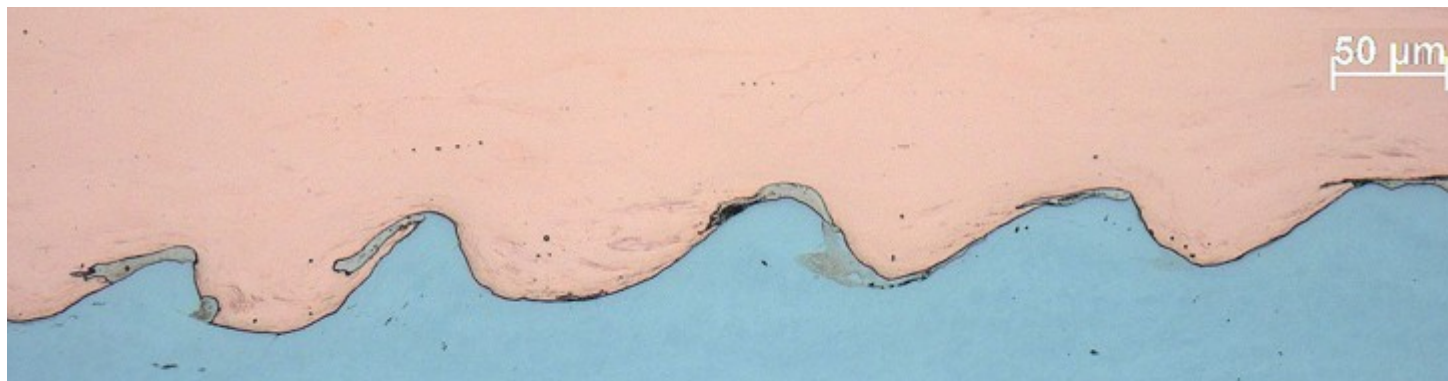
Figuur 5b: lasinterface van een verbinding koper/roestvast staal, niet aangeëist (x200)
