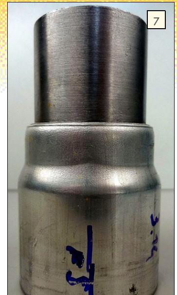
Fig. 6a: lasinterface van een typische verbinding koper/staal (x12) Fig. 6b: lasinterface van een verbinding koper/staal (x200) Fig. 6c: lasinterface van een verbinding koper/staal (x500); Fig. 7: verbinding van aluminium aan staal
