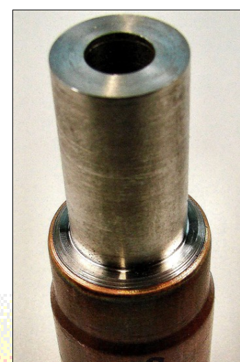
Figuur 4: lasverbinding van een koperen buis aan een inwendig stuk in roestvast staal
