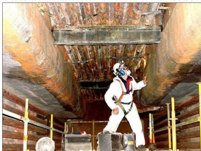
Figuur 1: Replica's kunnen genomen worden in besloten ruimten (zoals in een oven). Drie tassen aan materiaal worden meegenomen, voor replicaname op koolstofstaal. De replicalocatie moet bereikbaar zijn met het blote oog
