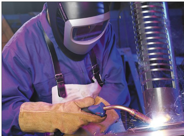
MIG/MAG lassen dankt zijn succes aan zijn flexibiliteit (groot applicatiegebied) en economische aantrekkelijkheid
