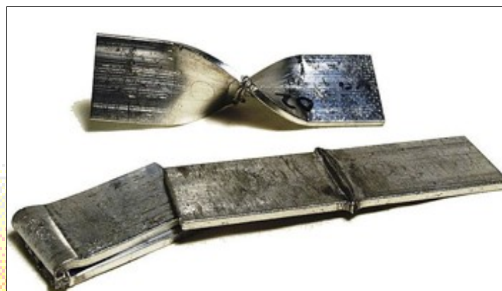
Figuur 12: Orbitaal wrijvingslassen van aluminium plaatjes (bron: Dyconn)
