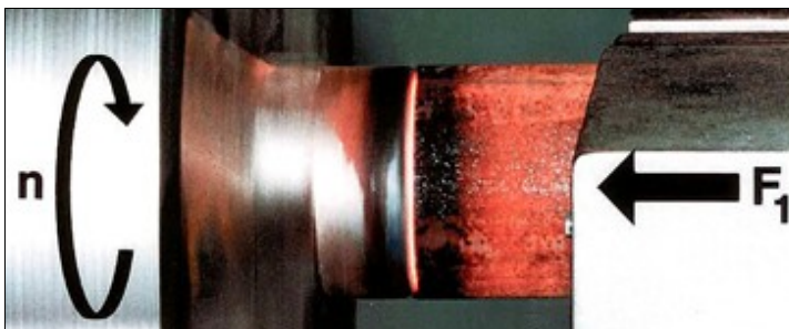
Figuur 5: De werkstukken worden met elkaar in contact gebracht met de wrijvingskracht F_1 ; de temperatuur stijgt in het contactoppervlak (bron: Kuka)
