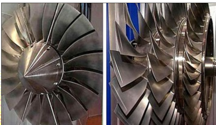
Figuur 11: Wrijvingsgelaste turbinebladen (bron: TWI)
