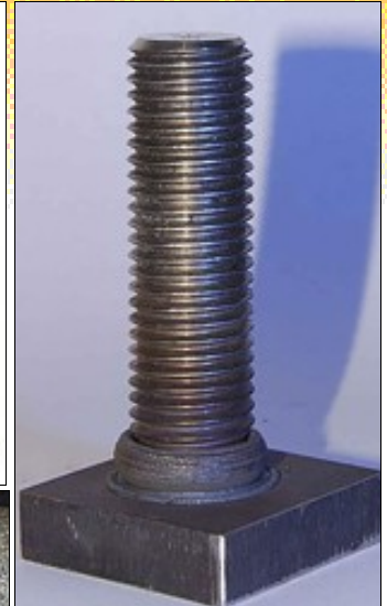
Figuur 13 (linksboven): Orbitaal wrijvingslassen van holle profielen (bron: Dyconn) Figuur 14 (midden): Frictionstirlassen Figuur 15 (onder): Frictionstirlasverbinding Figuur 16 (rechtsboven): Friction stud welding
