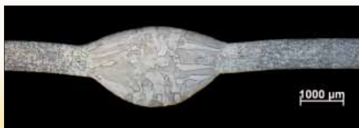
Figuur 1: AISI430Ti 0,7 mm - Cold Arc-proces
