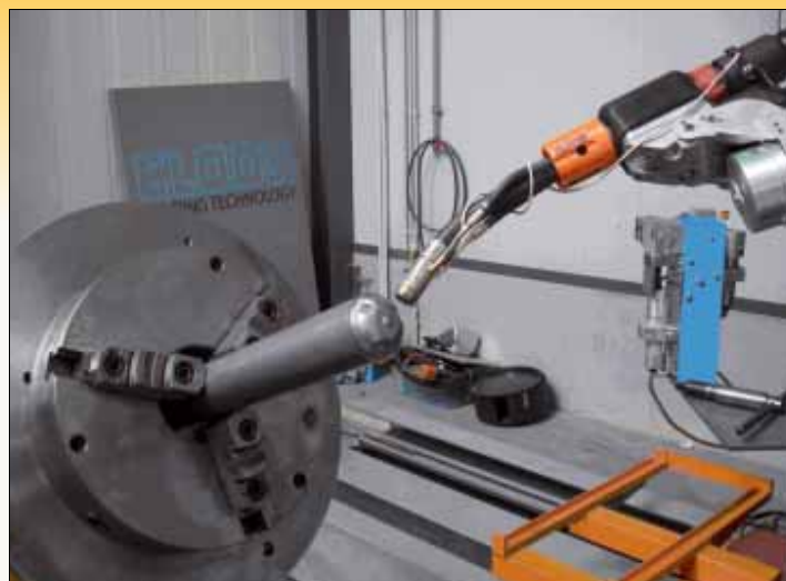
Figuur 4: testopstelling voor het lassen van een schokdemper onder 66° - Cold Process
