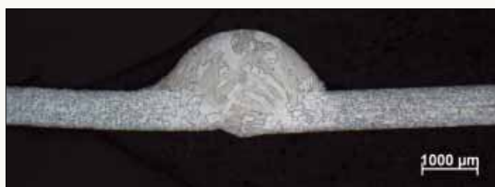
Figuur 2: AISI430Ti 0,7 mm – SP MAG-proces
