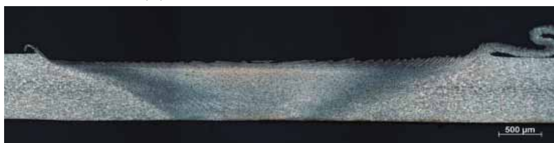
Figuur 6: Metallografische doorsnede van een friction stir las in 0,8 mm 5754-H111 materiaal, gelast aan 0,5 m/min
