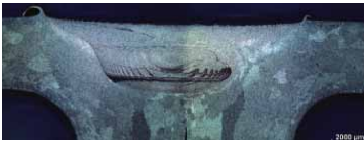
Figuur 3.1: Detail van de hoeken van twee extrusie profielen, verbonden door FSW
