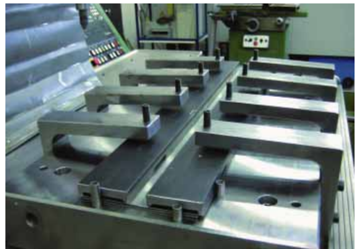
Figuur 5: Experimentele opstelling voor FSW van 0,8mm 5754-H111 materiaal bij UCL-PRM
