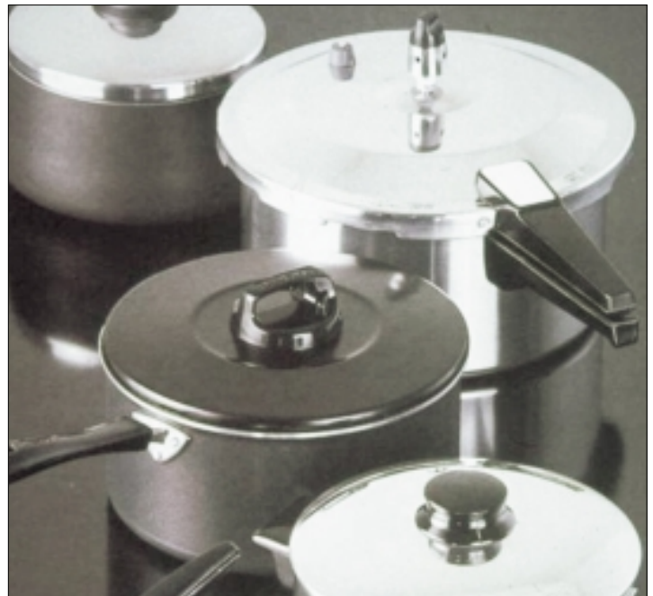
De aluminium-mangaan legeringen (0,05 - 1,8% Mn) kunnen bij hoge temperatuur worden ingezet (potten en pannen, warmtewisselaars, ...).
