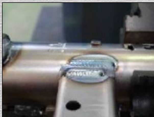
Figuur 9 : Gelaste stuurkolom met TOPTIG
