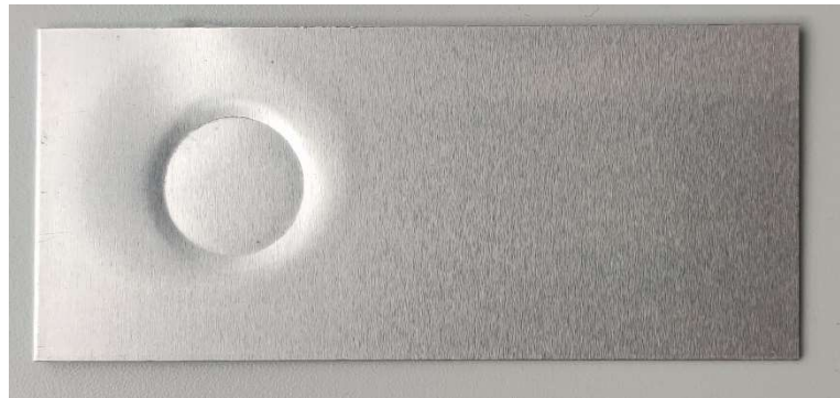
Figuur 12: Hylite MPC materiaal met verplaatste kern via ultrasone trillingen
