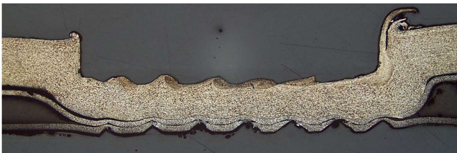
Figuur 30: Typisch lasdoorsnede van een ultrasoon las van een aluminium plaat en een MPC plaat
