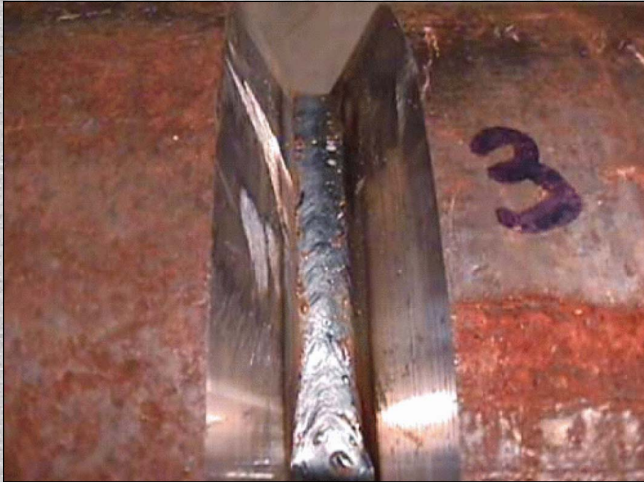
Figuur 3 : Oppervlak van een SST gelaste grondnaad in 15 mm dik pijpmateriaal [5]
