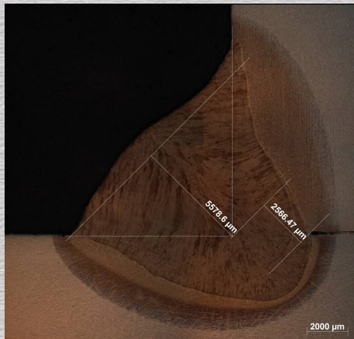
Figuur 2: Hoeklas op S355M met Sharc
