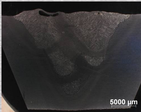
Figuur 47: S355 (20 mm) – Fast MIG Ferromaxx Plus Openingshoek 60° Afkeur wegens porositeit
