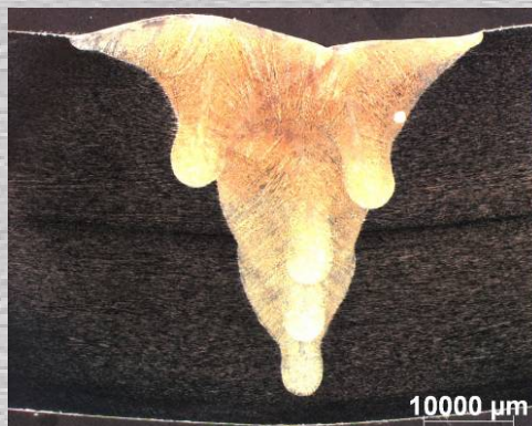
Figuur 51: AISI316L (20mm) Force Arc 97.5% Ar2.5%CO 2 Openingshoek 45° Voldoet niet aan de eisen volgens EN15614-1
