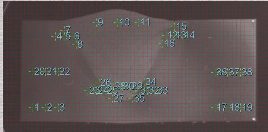
Figuur 87: Hardheidsmeting S700MC – Fast MIG
