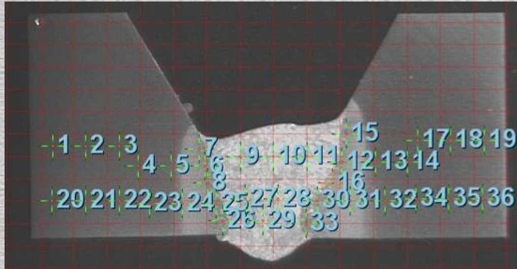
Figuur 61: Hardheidsmeting S500MC – Cold Arc manueel gelast
