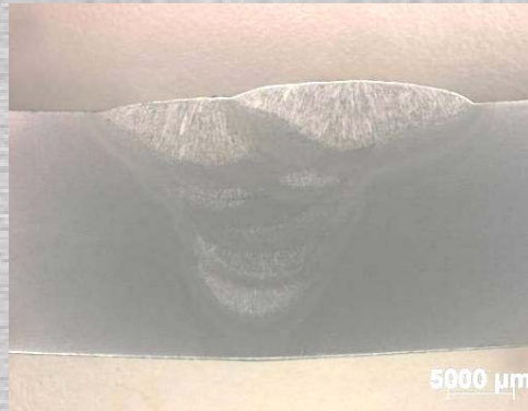
Figuur 49: S355 (20mm)OP Twin Arc (dubbele draadtoevoer) OK Flux 10.71 Openingshoek 60°
