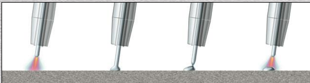
Figuur 1 : Schematische voorstelling CMT-proces
