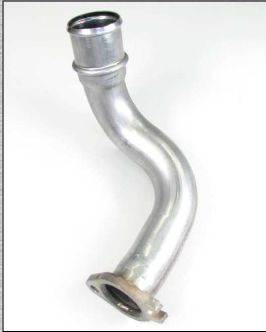
Figuur 11 : Flens – buis-verbinding gerealiseerd met het CMT-proces.
