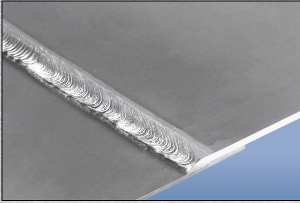
Figuur 9 : Overlapverbinding gerealiseerd met het CMT-proces tussen een aluminium bovenplaat en een stalen onderplaat.
