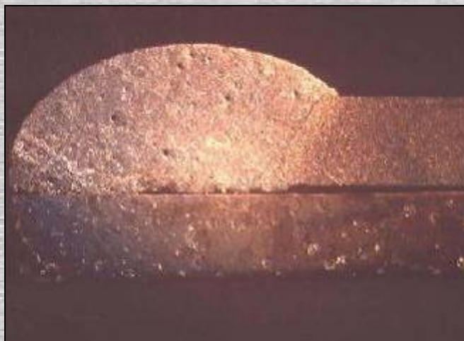
Figuur 8 : CMT - Samengestelde verbinding aluminium aan staal
