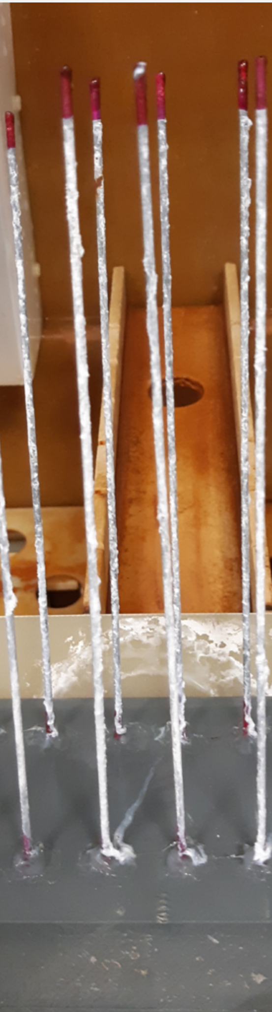
Voorbeeld verzinkte draden in zoutneveltest, met witte roest zichtbaar op de draden.
