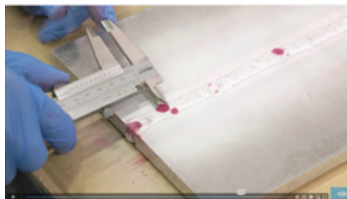
Opmeten van de indicaties tijdens het uitvoeren van een penetrant onderzoek
