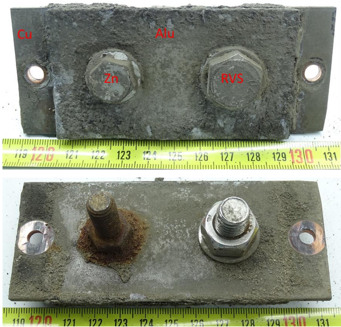
Figuur 4: Testplaatje koper en aluminium na atmosferische expositie (rijdend, onder bus), voor- en achterzijde. De voorzijde werd onmiddellijk blootgesteld aan spatwater tijdens de expositie, de achterzijde indirect. Testplaatjes na borstelen, niet-gereinigd in zuur. Corrosieproducten zijn zichtbaar op het aluminium. Bruinroest is zichtbaar op de zink-flake moer (contact koper). De kop van de zink flake bout vertoont deze rode roest niet.
