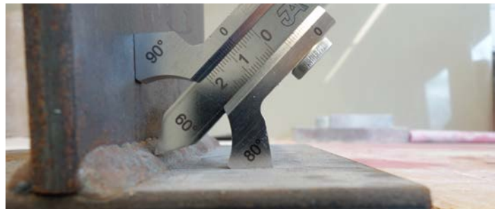
Mesure du diamètre de la gorge d'une soudure d'angle
