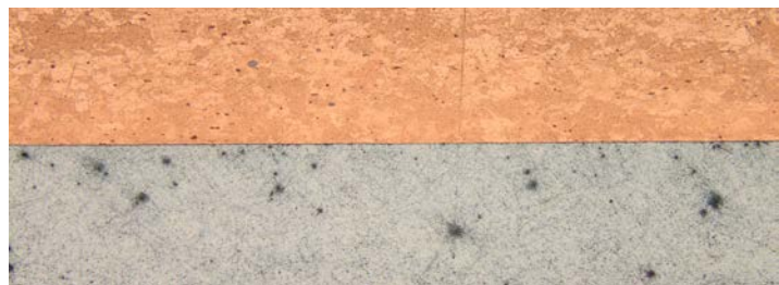
Aperçu détaillé d'une soudure Al - Cu (x100)
