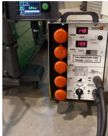
Calibration d'une source de soudage avec un banc de résistance
