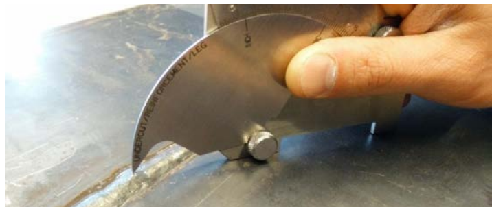
Mesure de l'épaisseur de la soudure
