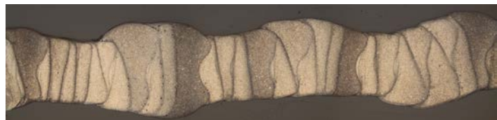
Détail d'une pièce plate en aluminium conçue par FA
