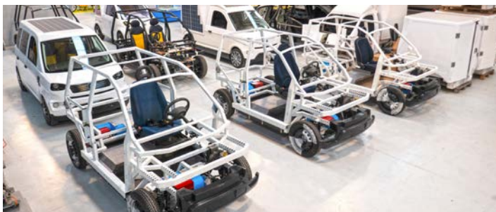
Véhicules électriques avec un châssis en acier haute résistance (Source : IFEVS - www.IFEVS.com)
