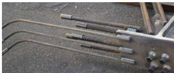
Gelaste verbindingen tussen wapeningsstaal en constructiestaal
