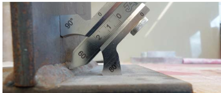
Opmeten van de keeldoorsnede van een hoeklas
