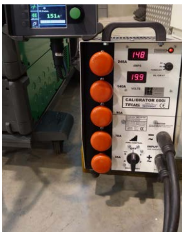
Kalibratie van een lasbron met een weerstandsbank
