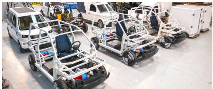
Elektrische voertuigen met een chassis in hoogsterkte staal (Bron: IFEVS – www.IFEVS.com)
