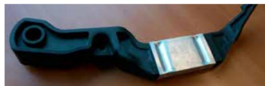
Prototype d'une pédale de frein hybride métal-composite, fabriquée au moyen de la technologie d'impulsion électromagnétique
