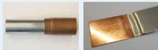
Jointes obtenus par soudage par impulsion électromagnétique du cuivre à l'aluminium
