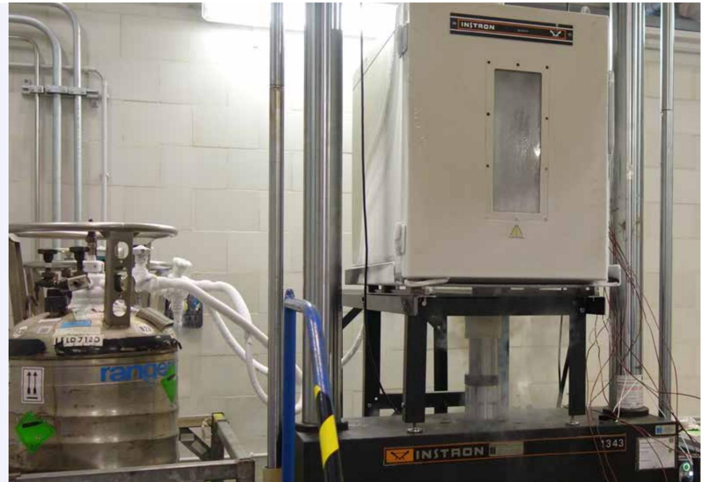
Armoire climatique configurée pour les essais sur l'acier 9%Ni à -165°C, refroidissement des éprouvettes par pulvérisation d'azote liquide
