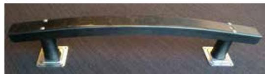
Prototype d'un pare-chocs hybride, fabriqué au moyen de la technologie d'impulsion électromagnétique
